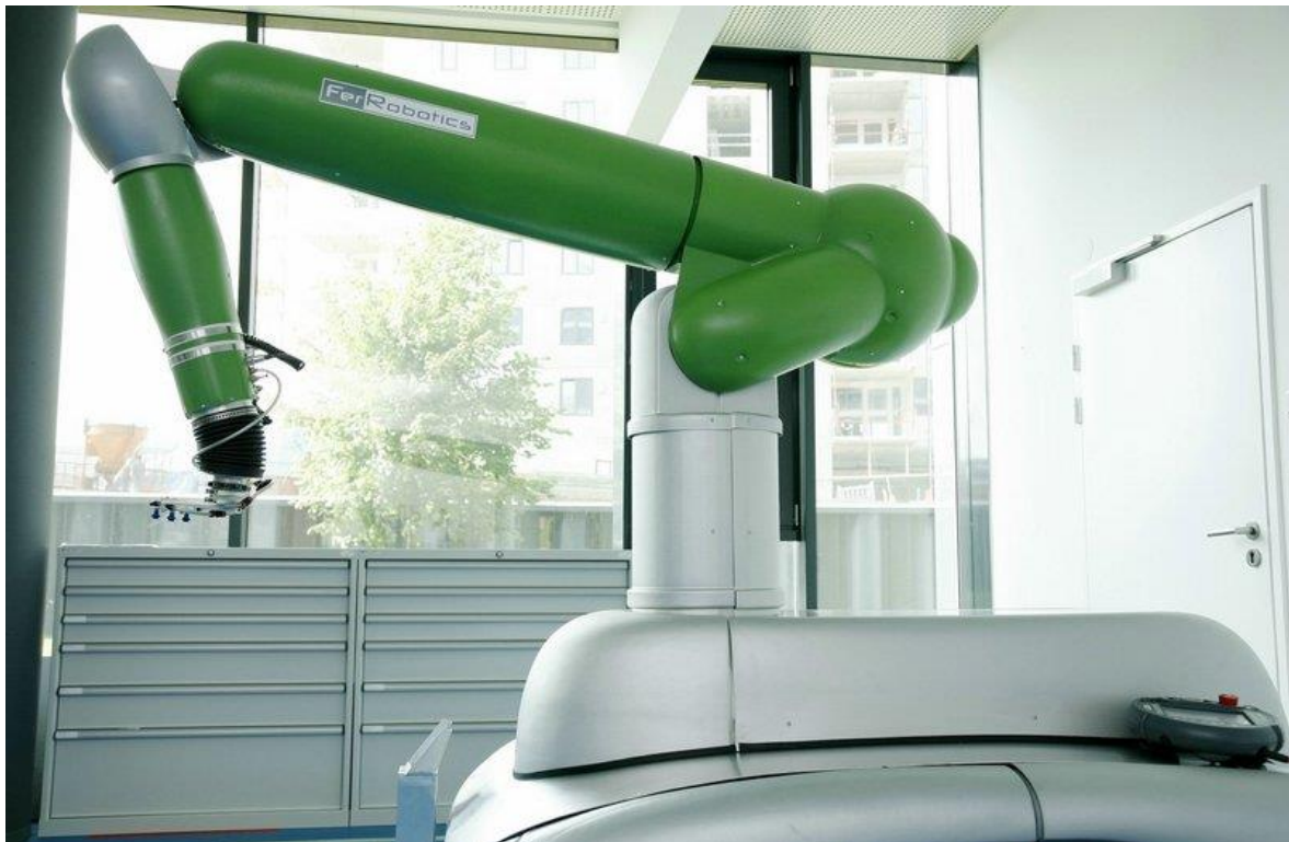
Abbildung 1: ROMO, 7-Achsen Roboter der Firma FerRobotics
